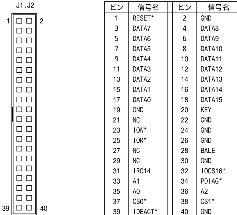
AS-3340 では、DiskOnModule を使用できるようになっております。DiskOnModule とは、3.5 インチ HDD EIDE と完全互換のインターフェイスを持ったフラッシュディスクモジュールです。このフラッシュディスクモジュールは「DiskOnModule」略して「DOM」と呼びます。
